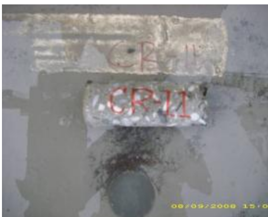
แท่งตัวอย่างคอนกรีตโดยวิธี Coring
