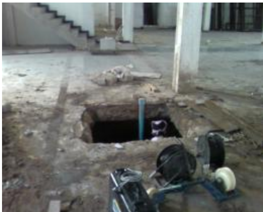
ภาพแสดงหลักการทดสอบ Parallel Seismic
