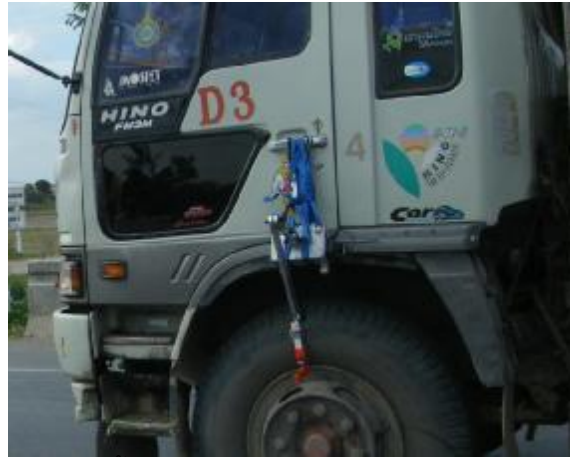
การติดตั้งอุปกรณ์ตรวจจับตำแหน่งล้อ Auto-Clicker
