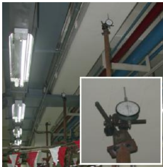
เครื่องมือวัดการแอ่นตัวของโครงสร้าง (Dial Gauge)
