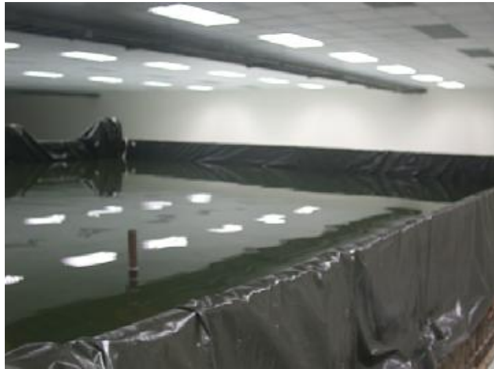
การทดสอบการรับน้ำหนักบรรทุกทุกโครงสร้างโดยใช้น้ำในการทดสอบ
