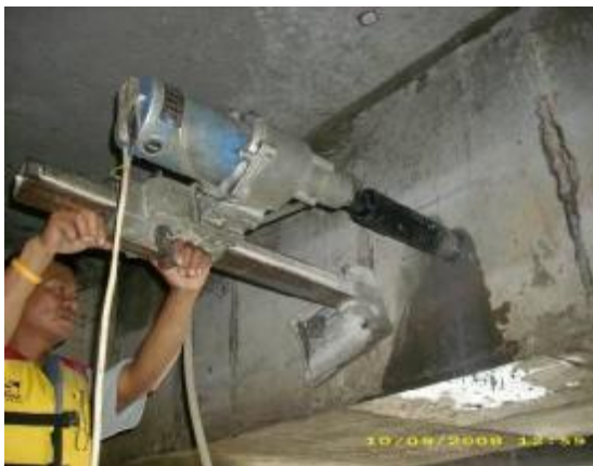
การเก็บตัวอย่างแกนคอนกรีตโดยวิธี Coring
