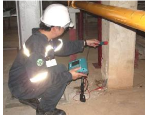
การทดสอบ Corrosion บนเสาคอนกรีต
