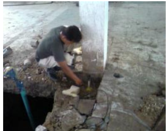
ภาพแสดงการทดสอบหาความยาวเสาเข็มโดยวิธี Parallel Seismic
