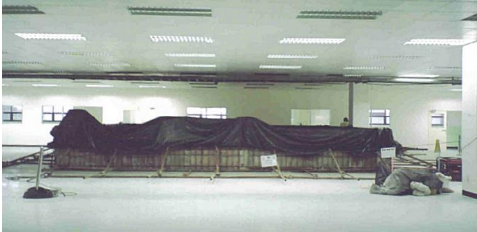
การทดสอบการรับน้ำหนักบรรทุกทุกโครงสร้างโดยใช้น้ำในการทดสอบ
