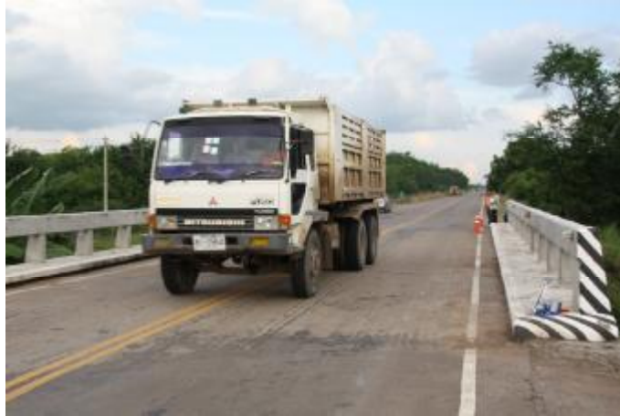
รูปที่ 2-3 ตัวอย่างการใช้รถบรรทุกทดสอบวิ่งด้วยความเร็วสูงเพื่อตรวจวัดคุณสมบัติทางพลวัต
