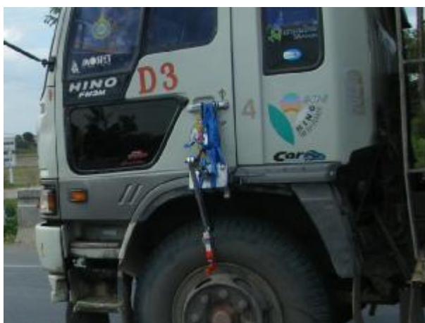
รูปที่ 5 การติดตั้งอุปกรณ์ตรวจจับตำแหน่งล้อ Auto-Clicker
